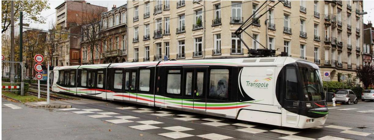
Le tramway BRED A est un véhicule bi-directionnel articulé comprenant quatre caisses en aluminium. Les caisses d'extrémités sont équipées d'une cabine de conduite, d'installations de traction et d'un bogie moteur. Les caisses intermédiaires sont équipées de roues porteuses. Les tramways sont munis de dispositifs lumineux qui mettent leur présence et leur sens de circulation en évidence. Les dispositifs comportent au moins un feu blanc à l'avant et un feu rouge à l'arrière.
